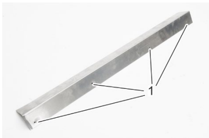
Abbildung 55: Bohrlöcher der Abdeckung der Reinigungsschiene
