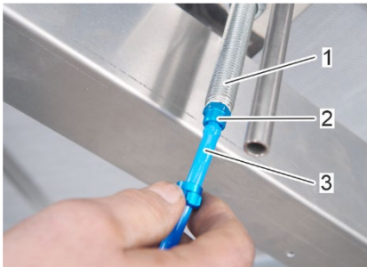
Abbildung 61: Druckluftschlauch in Druckluftdüse schieben
