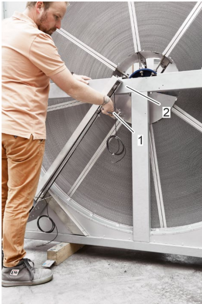
Abbildung 36: Obere Position des Reinigungsschlittens
