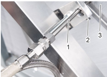
Abbildung 42: Abstand der Wasserdüse zur Rotoroberfläche einstellen
